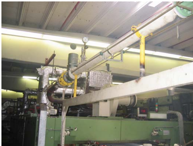
Famatex Spanrahmen , Baujahr 1977 , 6 Felder , horizontale Nadel Kuppenkette , gasbeheizt , Arbeitsbreite 2200mm , Abluftreinigung
