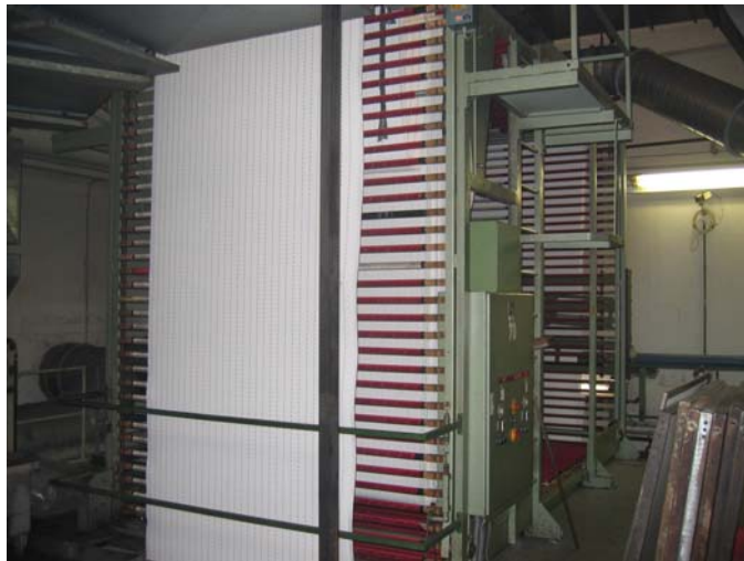
Überführung vom Spannrahmen Auslauf zum Holthausen Warenspeicher , Baujahr 1991 ,
