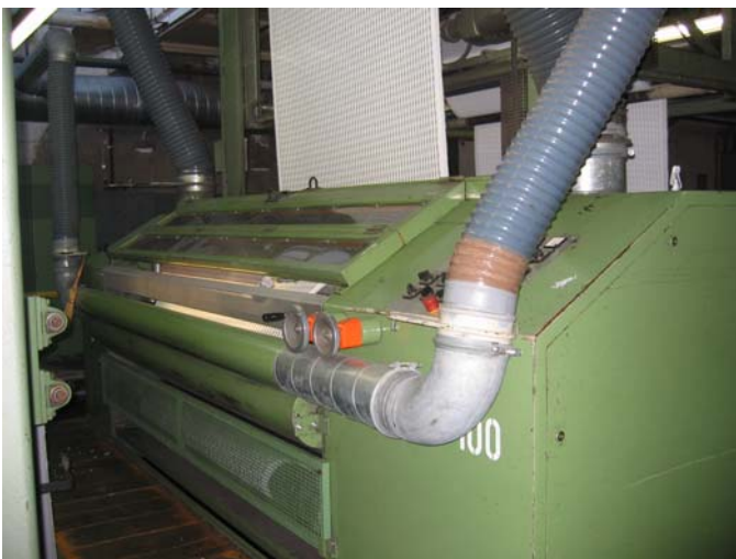
Einzelcylinder Schermaschine , Holthausen – Front- und Auslaufseite mit Wandertafler Holthausen
