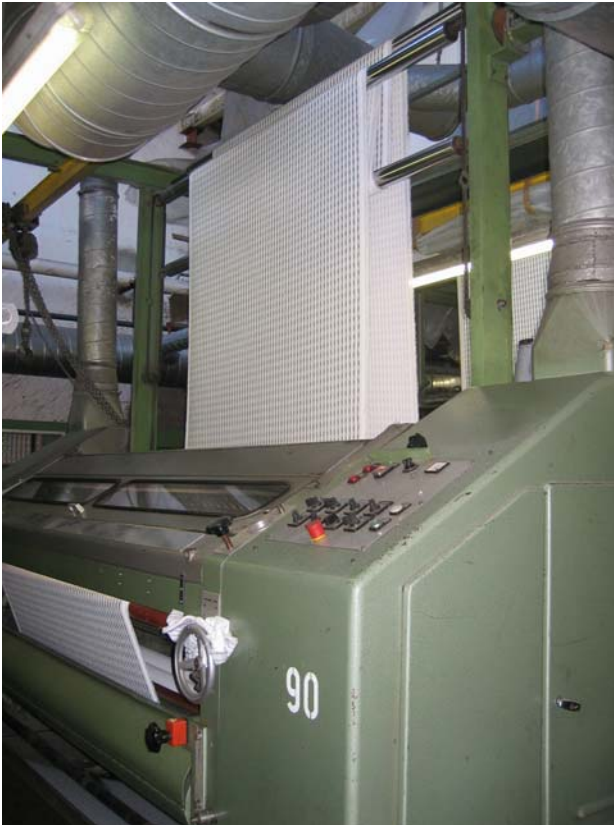
Einzelcylinder Schermaschine , Monforts – Einlaufseite / Auslaufseite mit Warenbahnmittelführer
