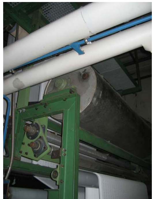
Entwässerungsfoulevard Küsters , alternativ Vacuumabsaugung , Fabrikat Evac , Heiztrommel zum Vortrocknen
