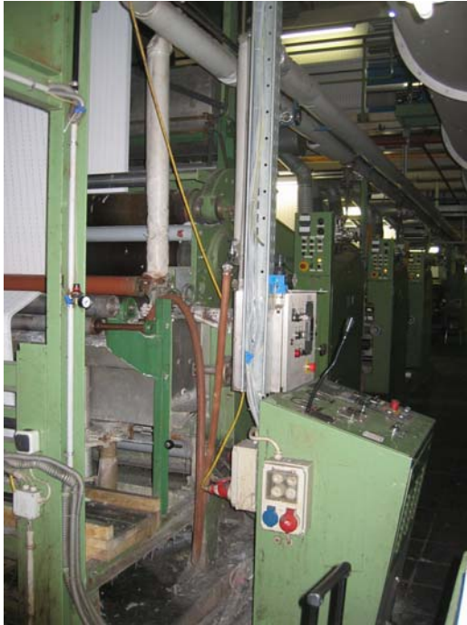
Entwässerungsfoulevard Küsters , alternativ Vacuumabsaugung , Fabrikat Evac , Heiztrommel zum Vortrocknen
