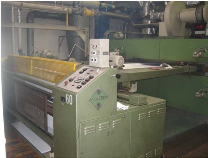
Famatex Spanrahmen , Baujahr 1977 , 6 Felder , horizontale Nadel Kuppenkette , gasbeheizt , Arbeitsbreite 2200mm , Abluftreinigung
