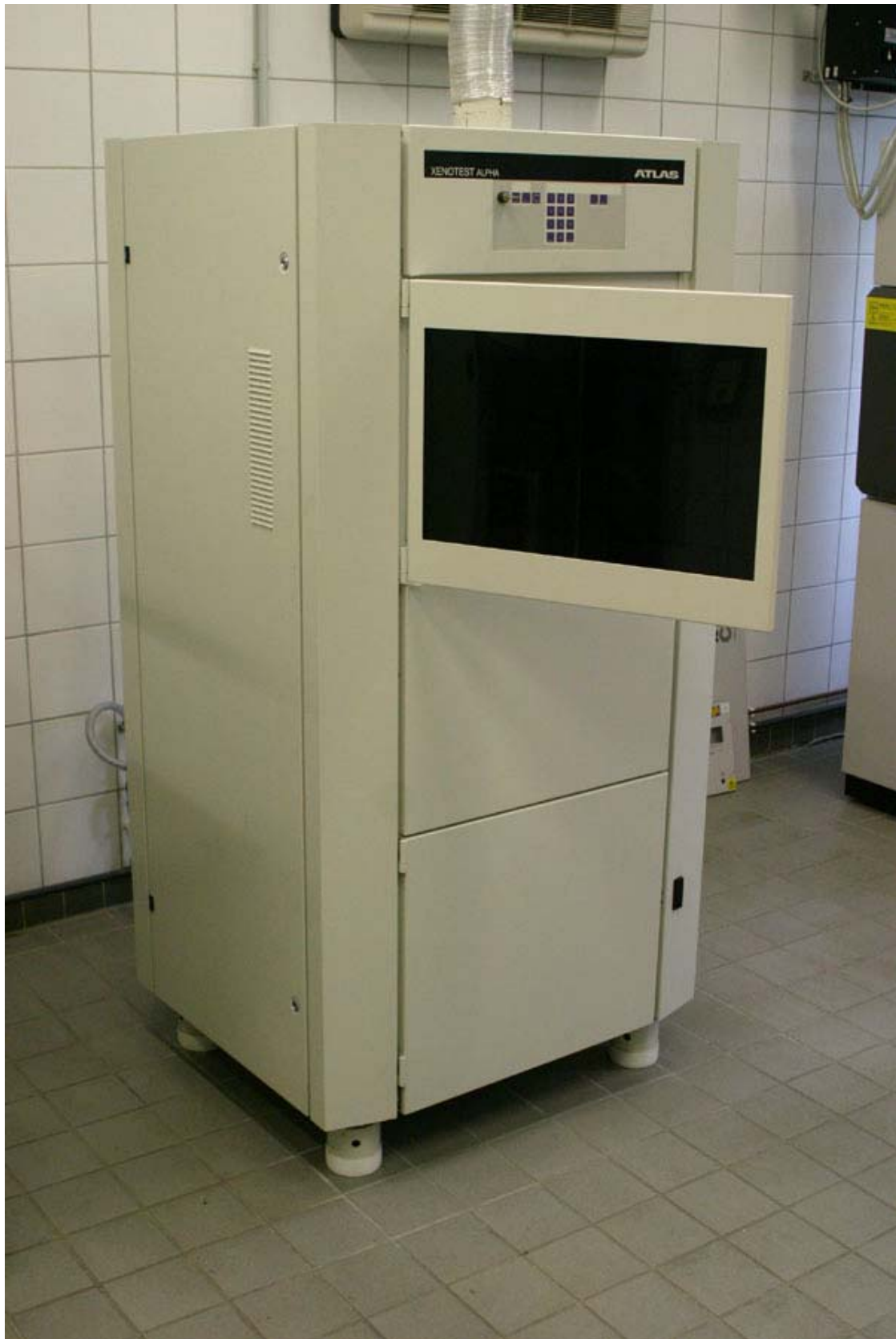
ATLAS XENOTEST Alpha Licht und Wetterechtheitsprüfgerät Luftgekühlter Xenonstrahler 2200 W
